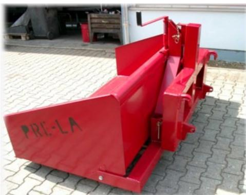
Abb. 7: kombiniert mit Adapter für Euroaufnahme
